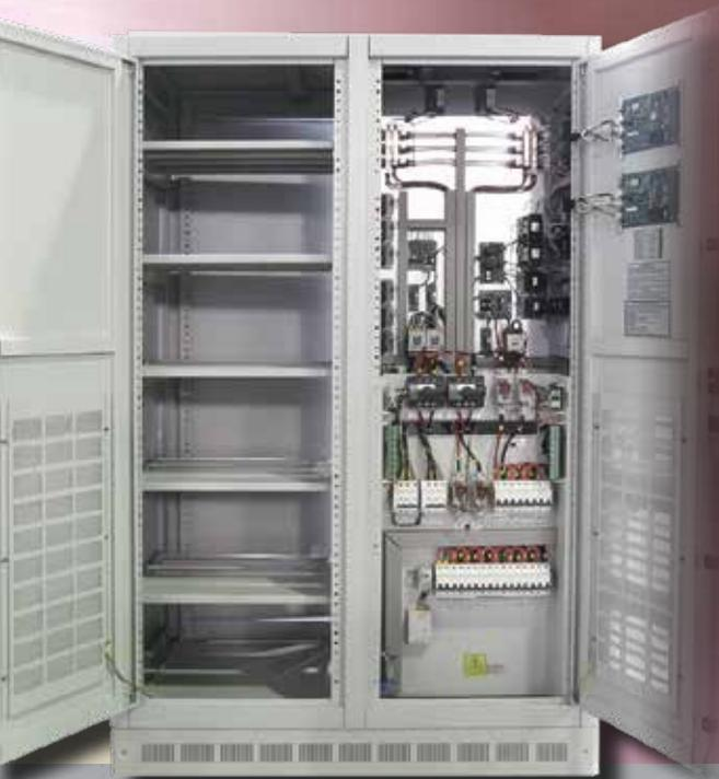
El Cargador de baterías PMI está controlado con tiristores, totalmente digital, rectificador estático AC/DC con característica de carga a voltaje constante y corriente constante. Aislamiento galvánico con transformador de entrada. El Cargador de Baterías PMI cuenta con protocolos de comunicación Modbus RTU y TCP/IP listo para integrarlo al sistema SCADA así como contactos secos.
